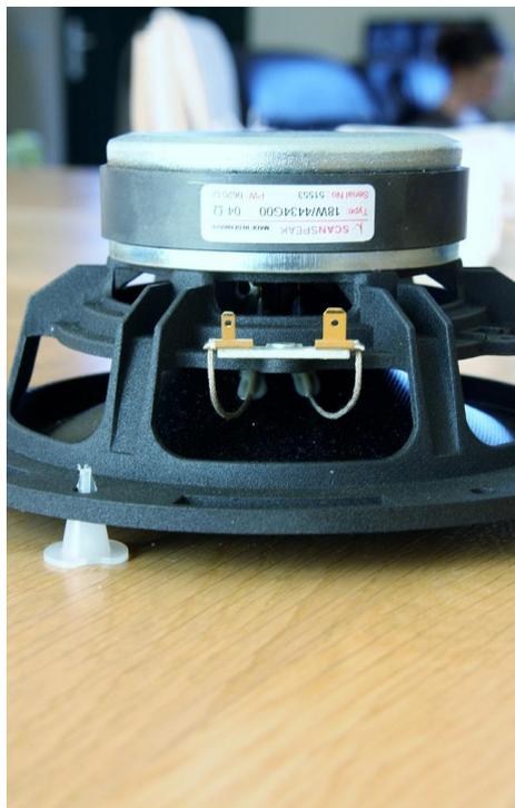
La pièce polaire est percée permettant de limiter les effets de compression et une bonne ventilation du moteur.
