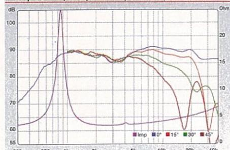
Unter 0° und 15° zeigt der Micro XT einen hervorragenden Frequenzgang. Ringstrahlertypisch strahlt er sehr gebündelt ab und gehört aufs Ohr ausgerichtet
