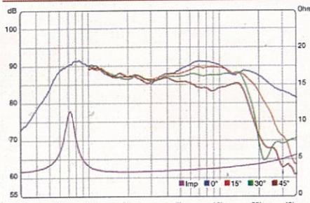
Der neue Scanspeak ist einer der breitbandigsten Hochtöner überhaupt. Er ist ab 2 kHz einsetzbar und läuft bis weit über 20 kHz
